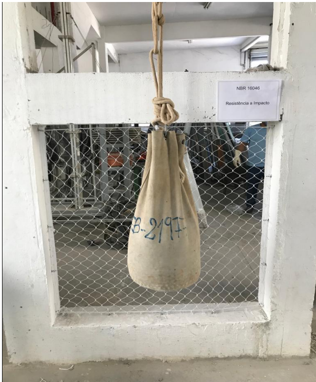
Fotos n.º 01 e 02 – Visualização do ensaio de resistência ao impacto e suas ocorrências.
