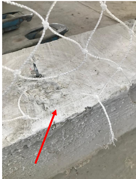
Fotos n.º 01 e 02 – Visualização do ensaio de resistência ao impacto e suas ocorrências.
