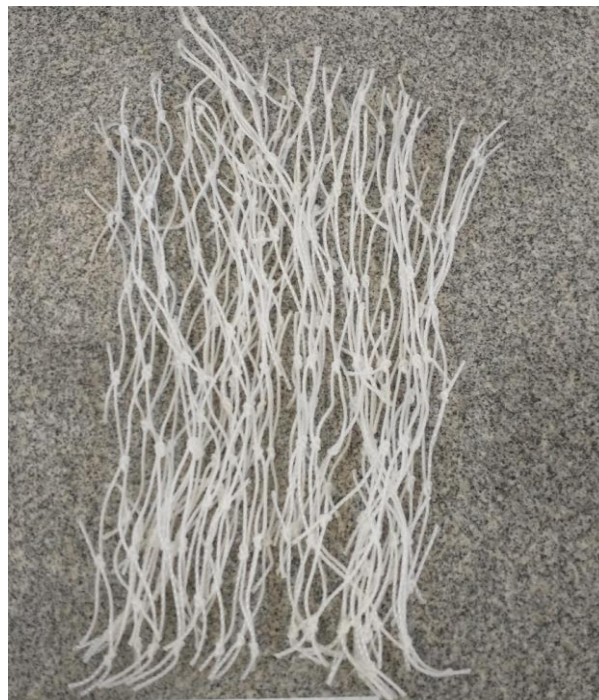
Foto 2. Amostra de rede após 2000 horas de exposição ao intemperismo.
